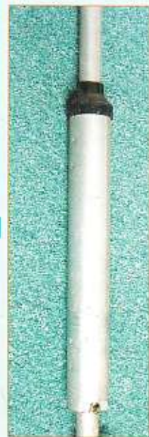
Commerciële trap, de buitenste buis beschermt de spoel en dient tevens zelf als condensator. Aan de bovenkant afgesloten met een sluitende kap.
